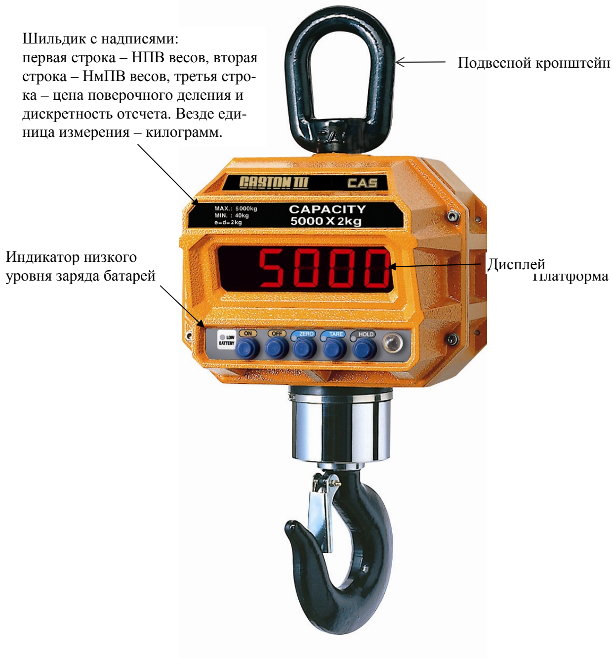
Рисунок 4.1 – Общий вид весов, основные элементы
